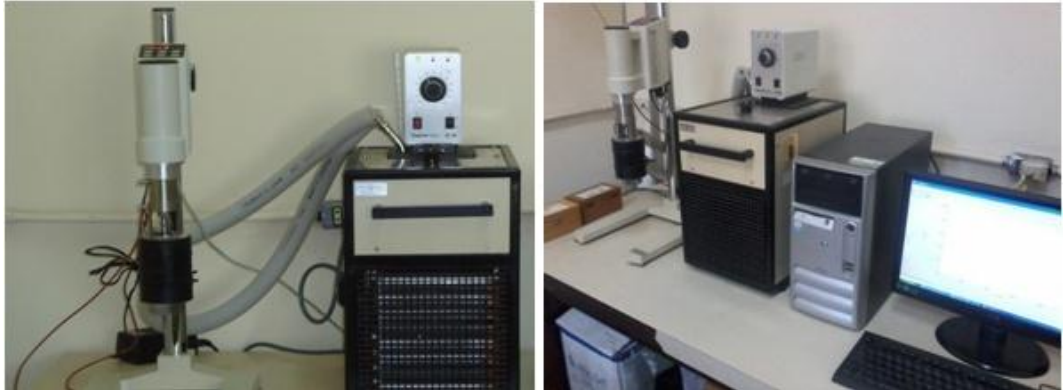
Figura 20: Viscosímetro rotacional Modelo Haake VT 550
