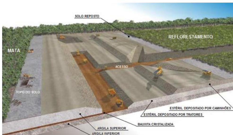
Figura 2 – Layout da sequência das operações de lavra
