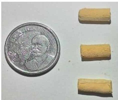
Figura 33. Imagem dos pellets com adição de cabelo elaborados após calcinação.
