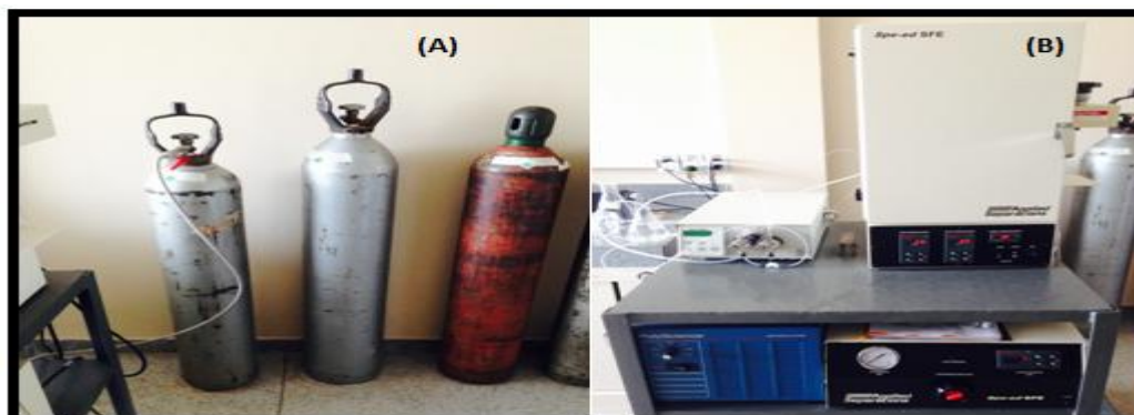
Legenda: Cilindros de CO 2 (A) e Sistema para extração montado (B)
