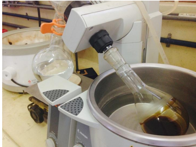
Figura 12: Destilação em rota evaporador em funcionamento
