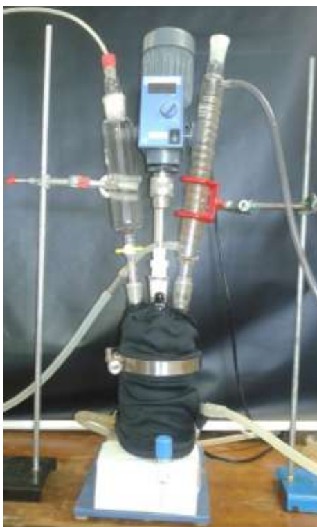
Figura 4 – Sistema para a síntese dos líquidos iônicos práticos.
