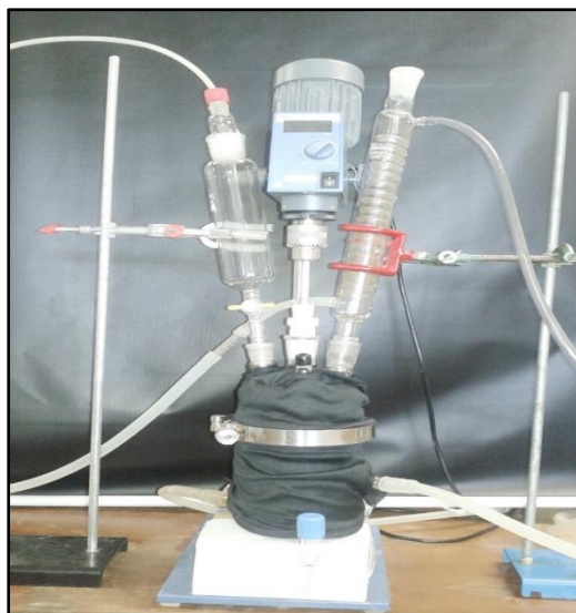
Figura 3.1: Aparato experimental utilizado para a síntese de Líquidos iônicos próticos.
