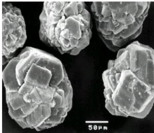
**Figura 4.2** - Microscopia eletrônica do adsorvente  $\gamma$  –alumina AG.650.
