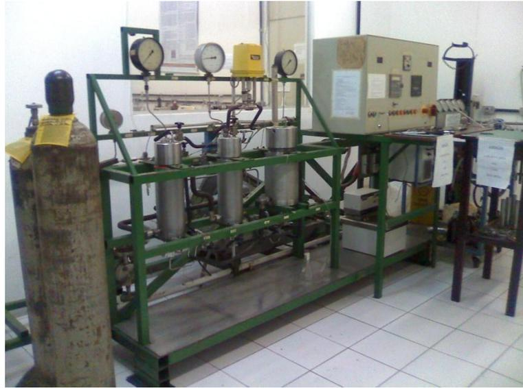
Fotografia 4.8: Unidade piloto de extração supercrítica.
