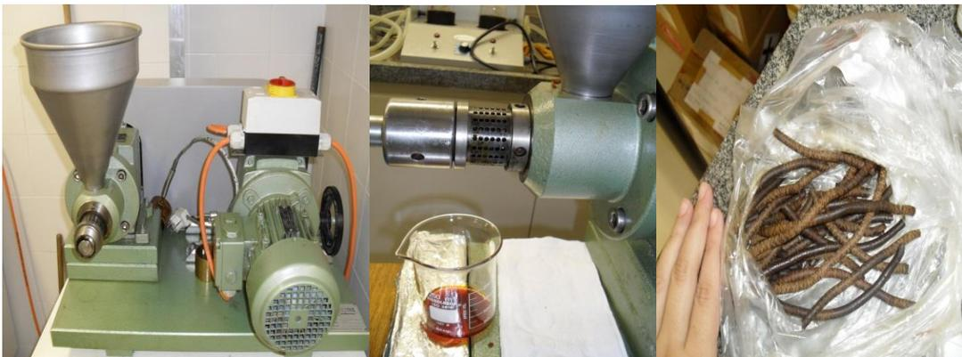
Fotografia 4.6: Prensa contínua tipo parafuso sem fim, utilizada na extração do óleo da polpa de buriti e torta.
