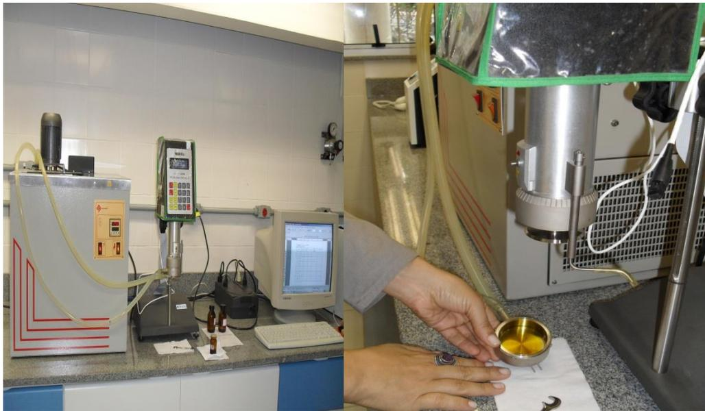
Fotografia 4.9: Reômetro-Brookfield e banho termostatizado
