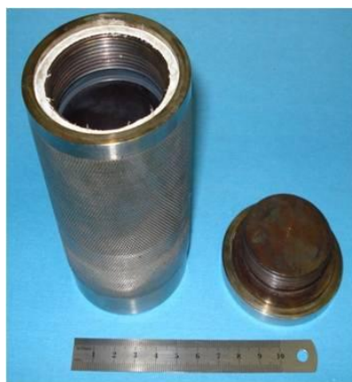
Figura 20: Autoclave de aço inox utilizada em todos os ensaios de síntese
