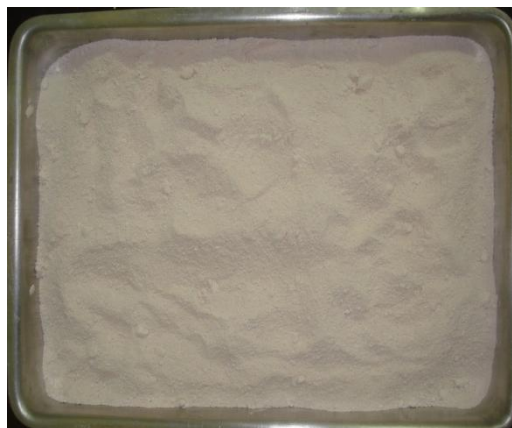
Figura 19: Rejeito de caulim RCC.
