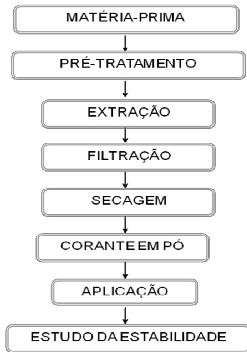
Figura 4.7 - Fluxograma do processo de medida da estabilidade do corante de urucum.
