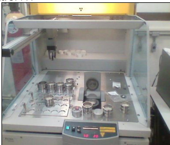
Fotografia 4 – Aparelho de fluorescência de raios X do laboratório de Raios – X do Instituto de Geociências/UFPA
