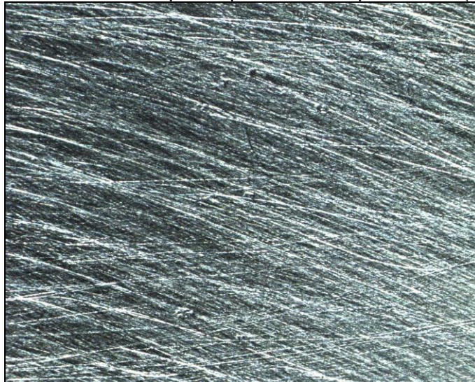
Fotografia 7 – Eletrodo de trabalho após o processo de polimento (Microscópio do LC)
