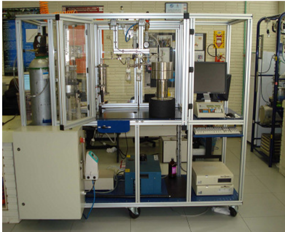
Fotografia 2 – Unidade piloto de extração Supercrítica
