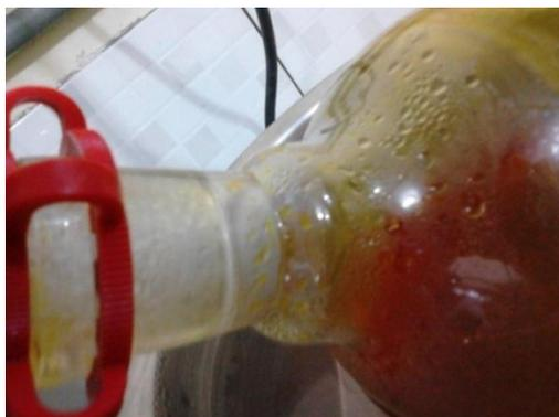
**Figura 43:** Água presente no óleo após o processo de desidratação.
