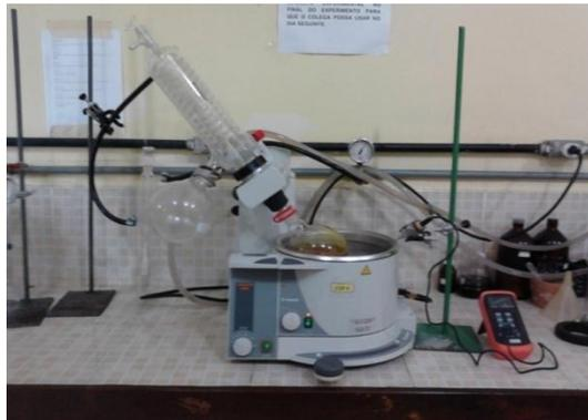
**Figura 19:** Equipamento utilizado para desidratação do óleo neutralizado.
