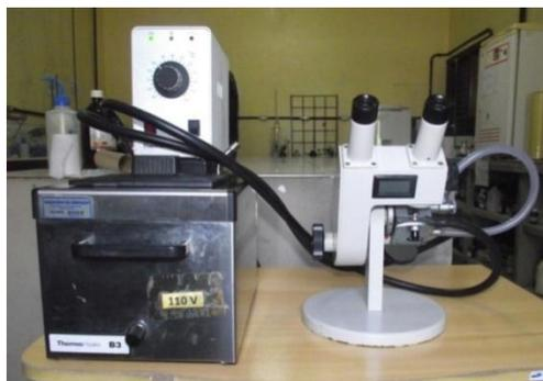
**Figura 14:** Refratômetro utilizado na Análise de índice de refração.
