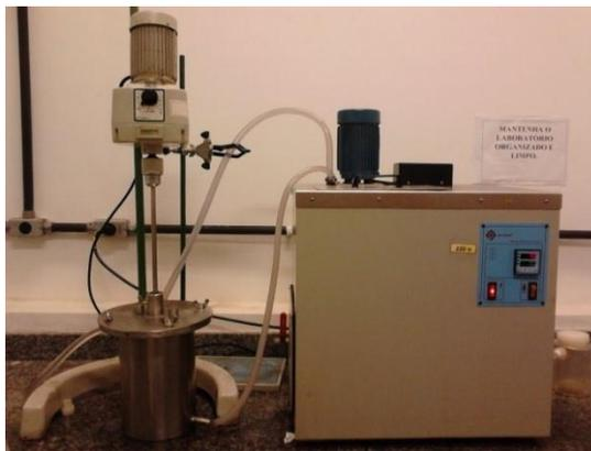
**Figura 20:** Sistema utilizado para a reação de transesterificação.
