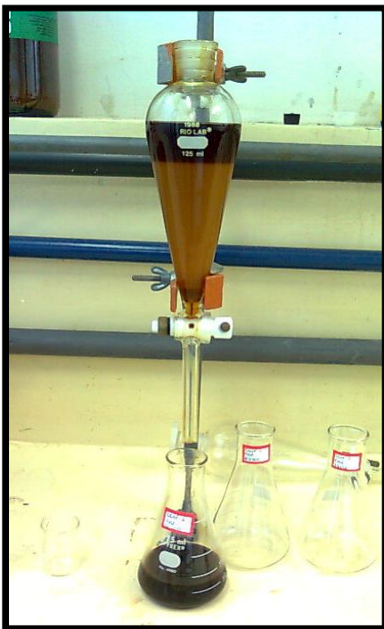
Fotografia 8: Aspecto da extração líquido-líquido dos extratos brutos.
