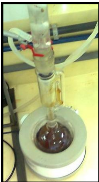
Fotografia 7: Extração com etanol utilizando o conjunto soxhlet, manta aquecedora e condensador.
