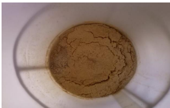
Figura 4.8: Sistema Monofásico Homogêneo (Gordura/Fase Aquosa) dentro do tanque de PEAD.
