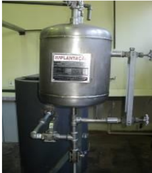
Figura 4.33: Sistema de Coleta do PLO da Unidade Piloto. Fonte: O autor.
