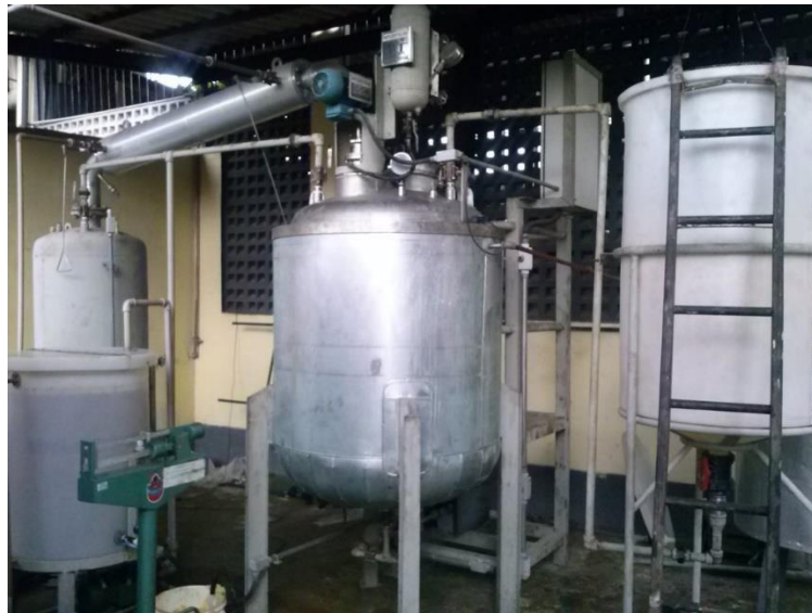
Figura 4.9: Unidade Piloto de Desodorização/Desidratação – Laboratório THERMTEK. Fonte: O autor.
