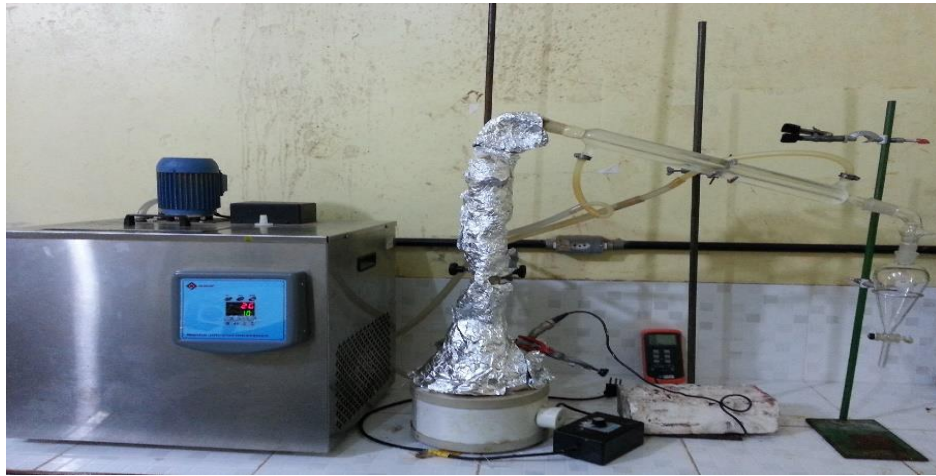
Figura 4.45: Unidade de Destilação Fracionada em Escala de Bancada – Laboratório THERMTEK.
