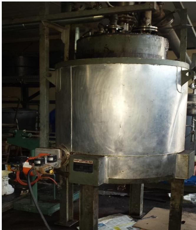
Figura 4.28: Reator de Leito Agitado do Sistema Reacional da Unidade Piloto.
