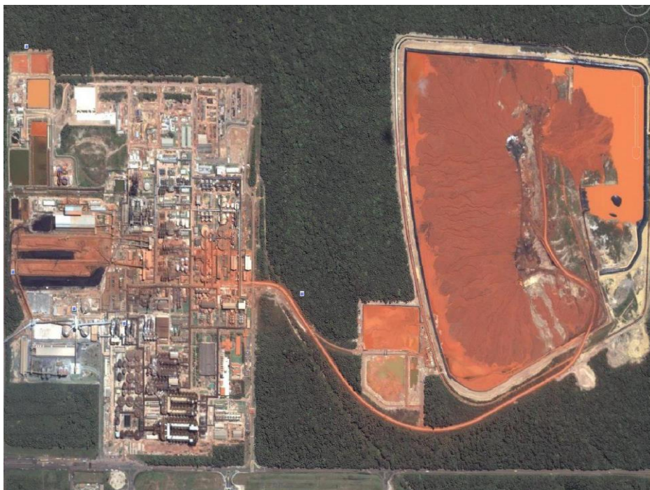
Figura 3.7: Imagem aérea da fábrica da ALUNORTE (Barcarena – PA) e da Lagoa de rejeitos sólidos onde é estocada a lama vermelha proveniente do processo Bayer.
