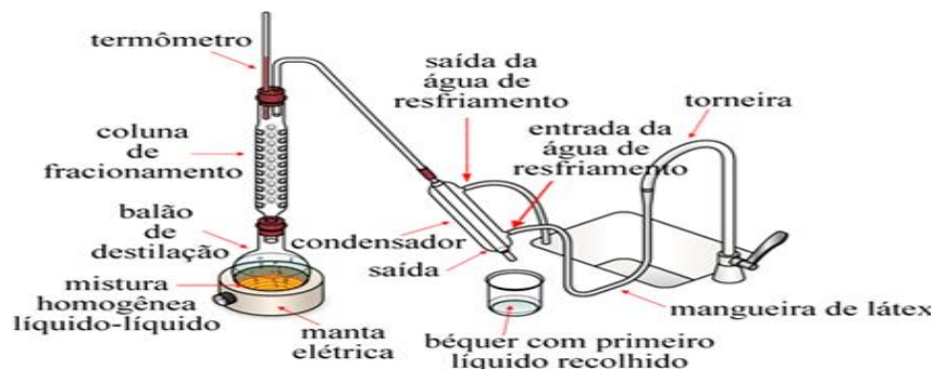
Figura 3.12: Esquema de Destilação Fracionada em Escala Laboratorial.
