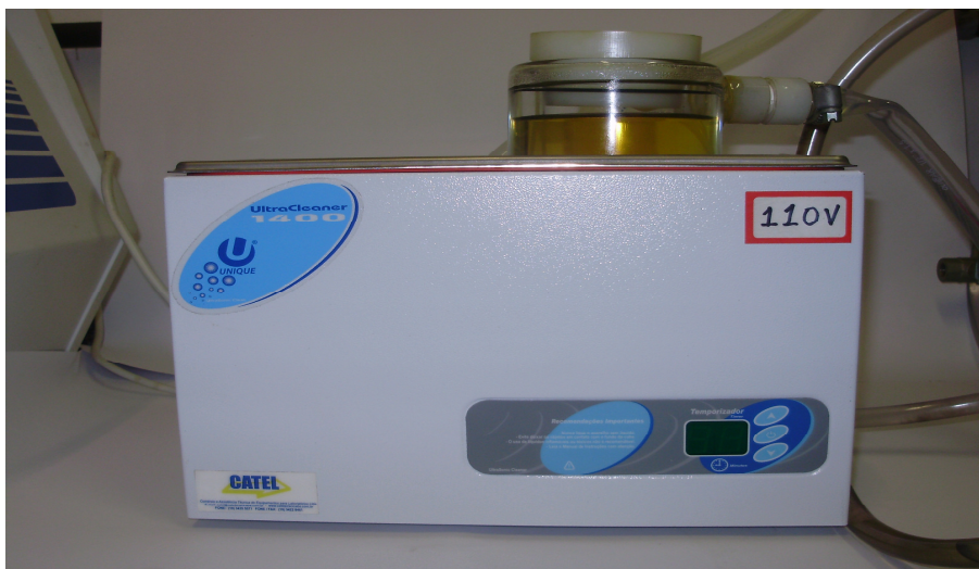
Figura 4.4. Sistema para transesterificação ultrassônica
