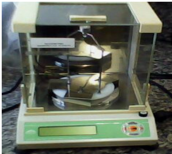
Figura. 4.1. DSL 900 medidor de densidade de sólidos e líquidos
