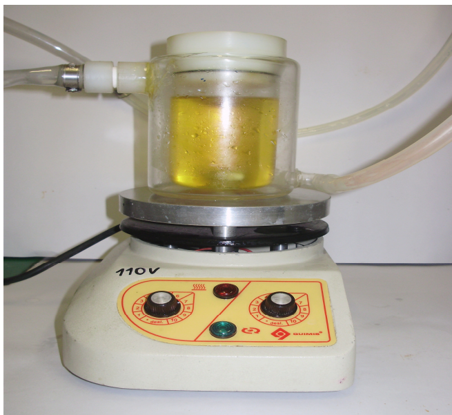
Figura 4.5. Sistema para transesterificação por turbulência via agitação magnética
