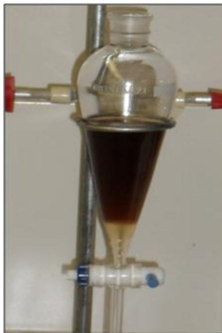
Fotografia 5: Funil de decantação com biodiesel de murumuru e glicerina límpida após 24 horas
