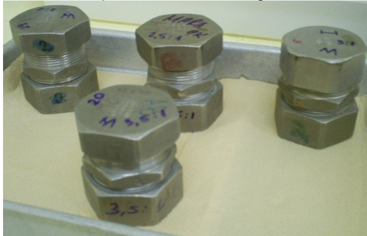
Fotografia 4 - Autoclaves de aço inoxidável utilizadas para síntese de zeólita P.
