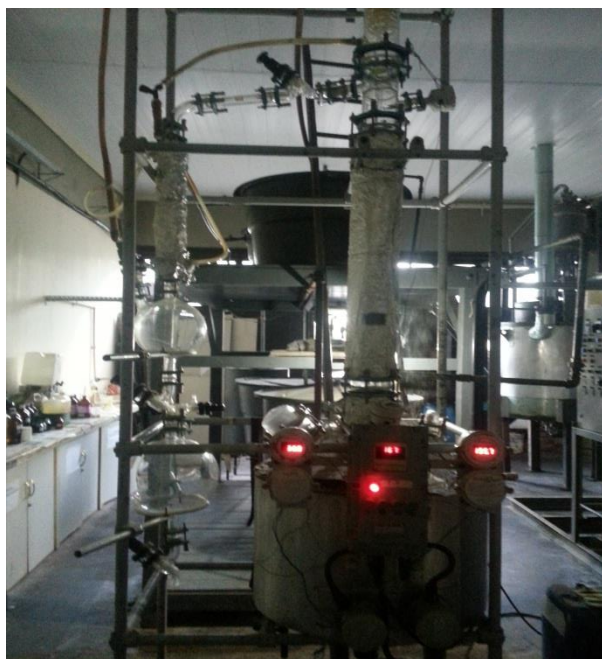
Figura 4.43- Unidade Piloto de Destilação. Fonte: O autor.
