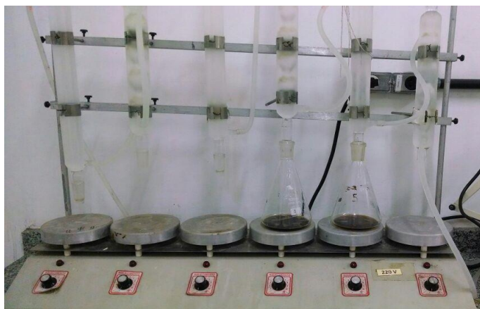
Figura 4.9- Equipamento utilizado para realizar o índice de saponificação. Fonte: O autor.
