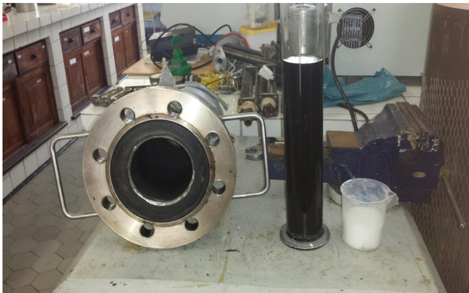
Figura 4.21- Gordura Residual e Carbonato de Sódio sendo depositados no Reator. Fonte: O autor.
