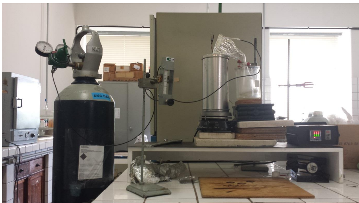
Figura 4.14 - Unidade de Craqueamento em Escala de Bancada (Laboratório de Catálise/IME). Fonte: O autor.
