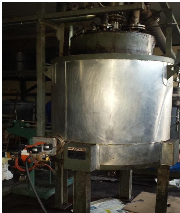
Figura 4.27- Reator de Leito Agitado do Sistema Reacional da Unidade Piloto.
