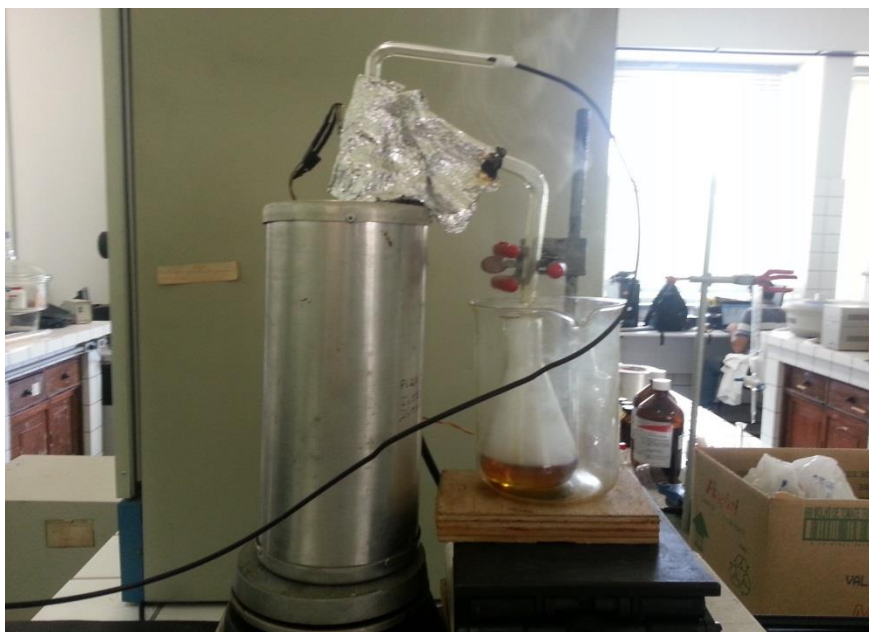
Figura 4.17- Forno Cilíndrico com Resistência Cerâmica. Fonte: O autor.
