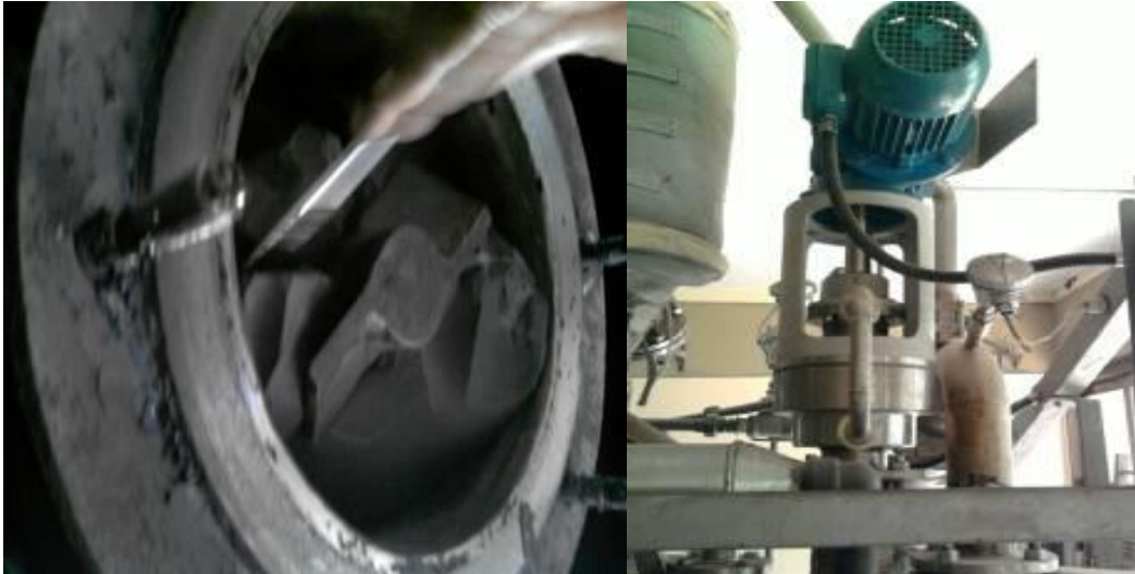
Figura 4.28- Sistema de Agitação da Unidade Piloto. Fonte: MOTA, 2013.
