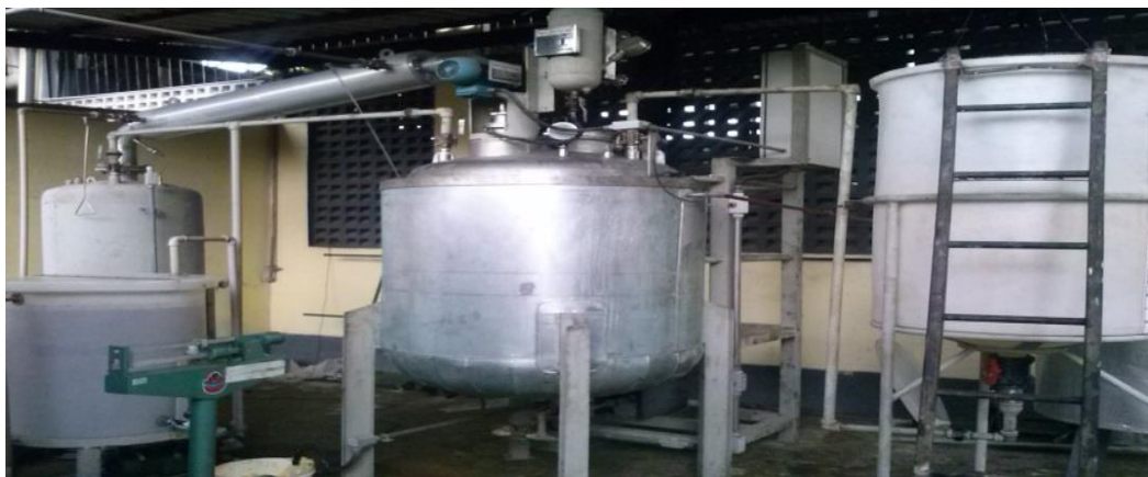
Figura 4.6 – Unidade Piloto de Desodorização/Desidratação (THERMTEK/FEQ/UFPA). Fonte: O autor.
