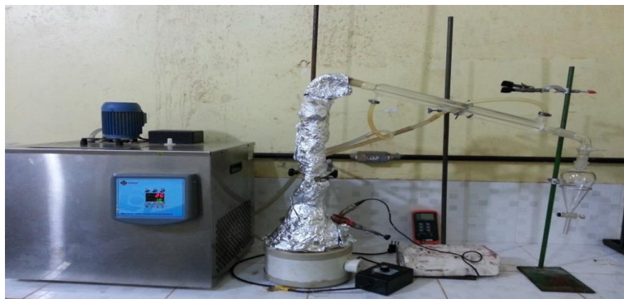
Figura 4.41- Unidade de Destilação Fracionada em Escala de Bancada. Fonte: O autor.
