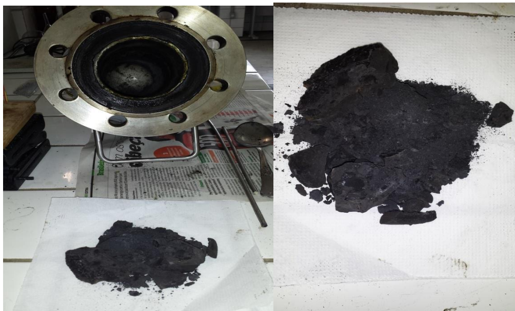
Figura 4.22- Resíduo (Coque) sendo retirado do Reator para pesagem.
