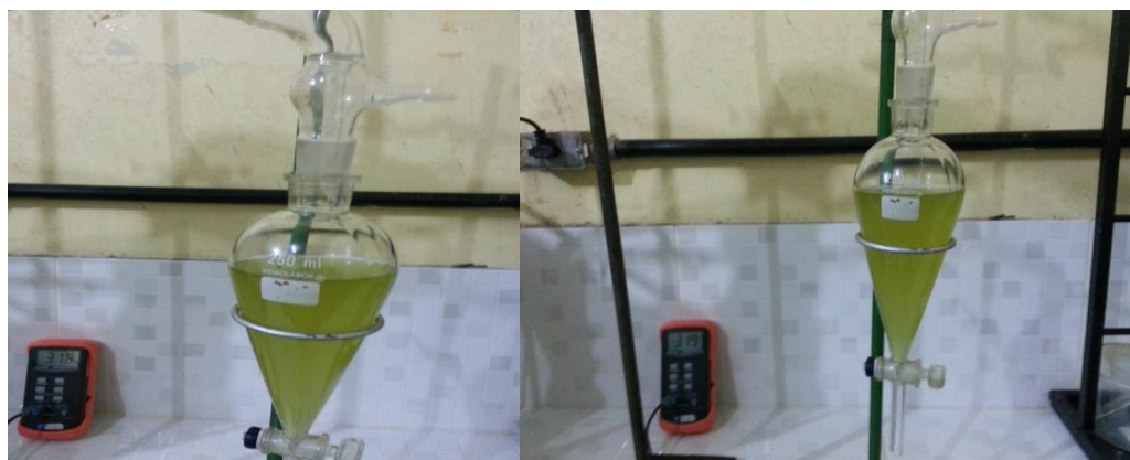
Figura 4.42- Frações Obtidas no Processo de Destilação na Unidade de Bancada. Fonte: O autor.
