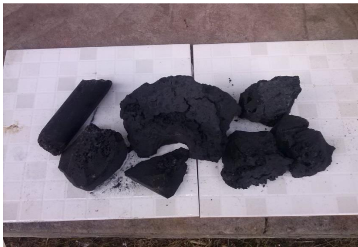
Figura 4.36- Coque retirado do Reator após a reação de Craqueamento.
