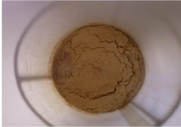
Figura 4.5 – Sistema Monofásico Homogêneo (Gordura/Fase Aquosa) dentro do tanque de PEAD. Fonte: O autor.
