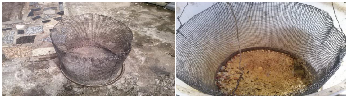
Figura 4.4- Peneiramento e retenção de resíduos dentro do tanque de PEAD. Fonte: O autor.
