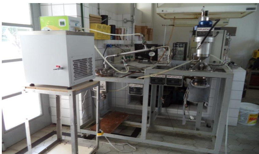
Figura 4.19- Unidade de Craqueamento em Escala Semi-Piloto (Laboratório de Catálise/IME). Fonte: O autor.
