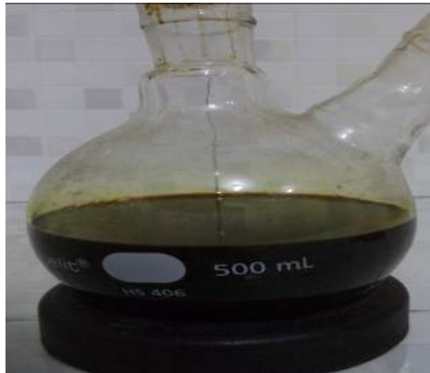
Figura 20 – Material residual ou produto de fundo do processo de destilação. Fonte: O AUTOR.
