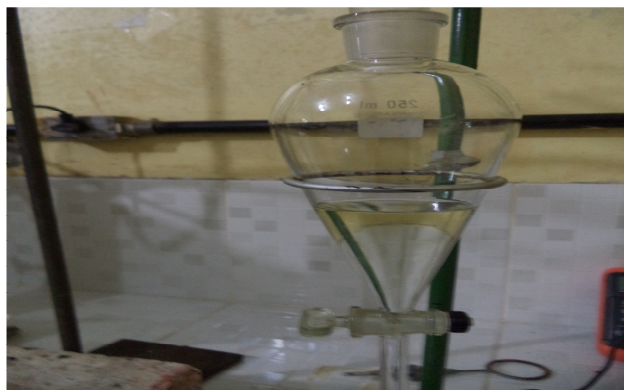
Figura 18 – Gasolina obtida na destilação do craqueamento termocatalítico com 15% de alumina ativada com solução de NaOH a 20%.
