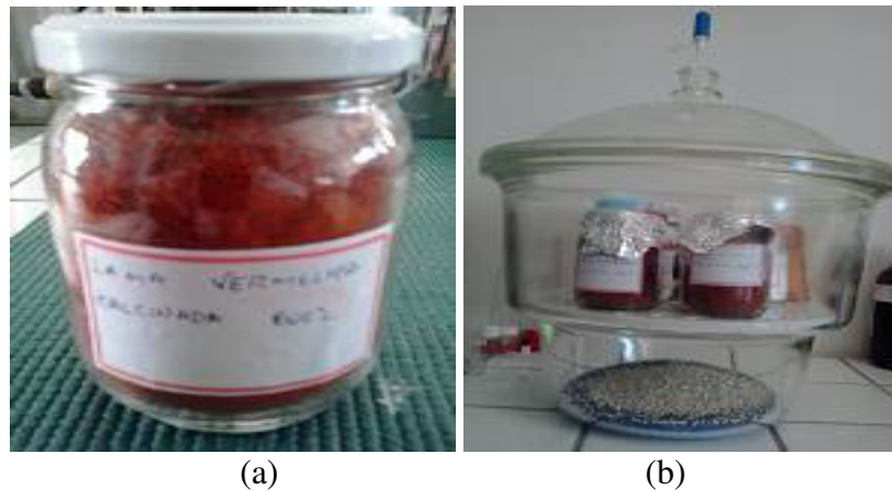
Figura 12 - (a) lama vermelha calcinada a 800 °C, (b) lama vermelha calcinada a 1000 °C. Fonte: O AUTOR.
