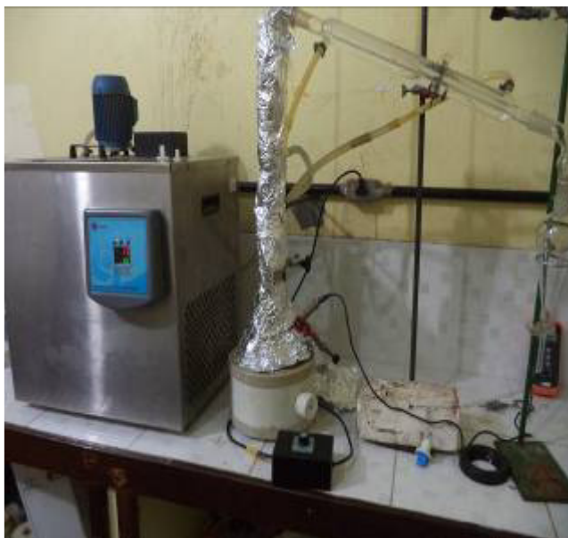
Figura 17 – Aparato Experimental de Destilação Fracionada em Escala de Bancada. Fonte: O AUTOR.
