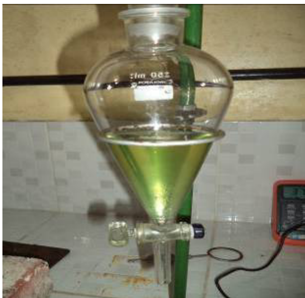
Figura 19 – DP da destilação do produto craqueado, da Unidade Semipiloto, obtido com 15% de LV calcinada a 800°C.
