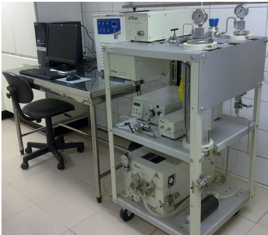
Figura 17. Sistema de extração com fluido supercrítico – marca Thar modelo SFE 2000- 2-C10.
