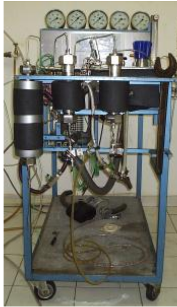
Figura 2. Unidade de extração supercrítica da FEQ/UFGA.
